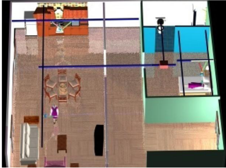
Imagen 12. Casa adaptada con rieles para el movimiento del robot
