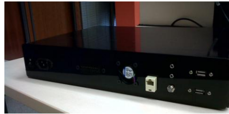
Imagen 8: Conexiones externas del set-top box o caja SocialTV
