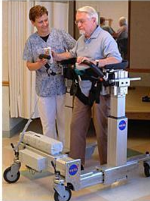
Imagen 9. Robot comercial en la rehabilitación de la Marcha: SAM.
